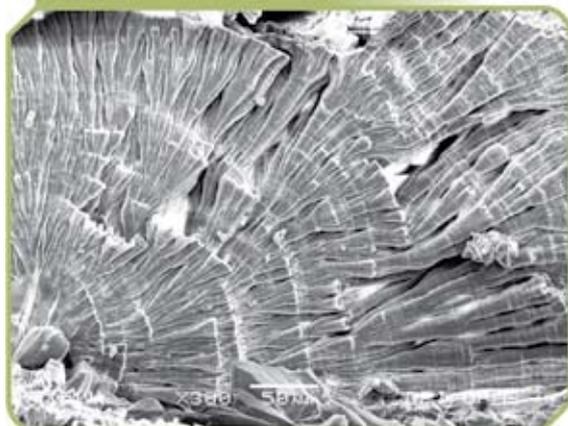
Figura 9 – Micrografia dos produtos cristalizados nos poros da amostra T1
