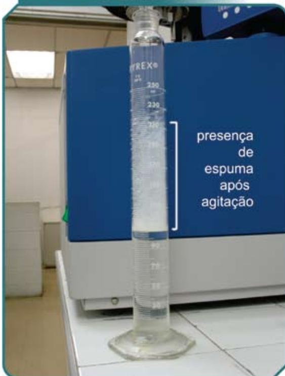
**Figura 3 – Amostra de água tratada com NaOH para avaliação da presença de matéria orgânica**
