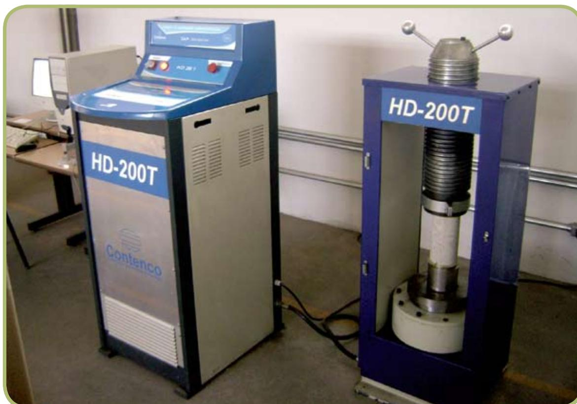
Figura 1 - Detalhe do ensaio da resistência à compressão do concreto
